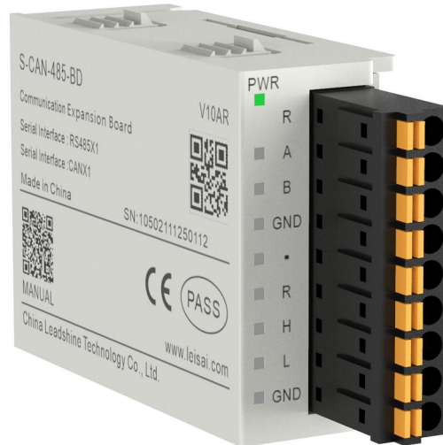
图 6-7 S-CAN-485-BD扩展板外观及端子定义图
